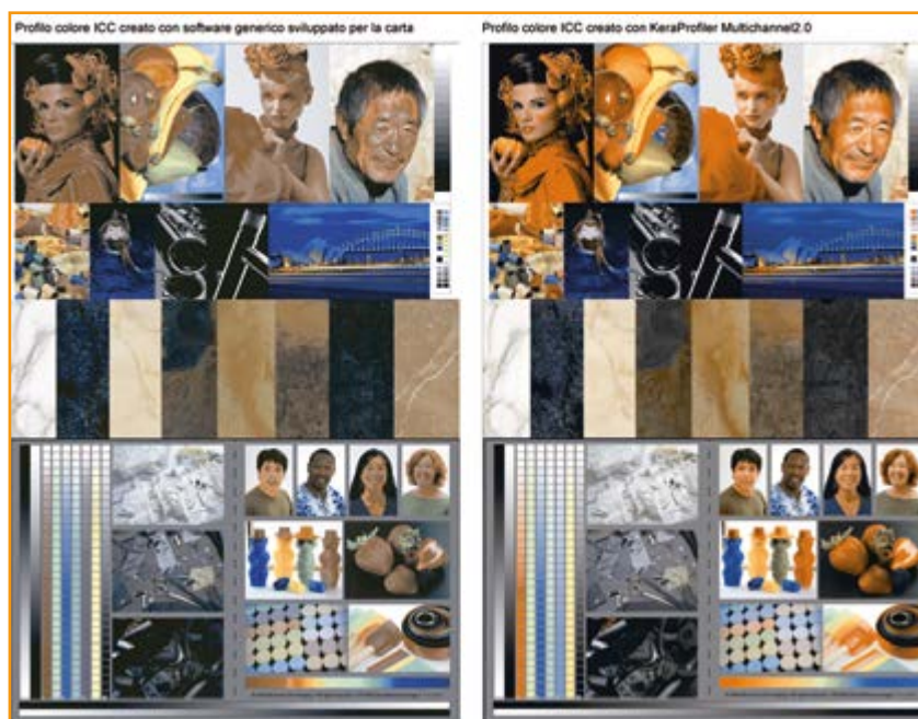
FIG. 9 - Confronto tra profilo colore ICC creato con software generico sviluppato per la carta (a sinistra) e profilo colore ICC creato con Keraprofiler Multichannel 2.0
